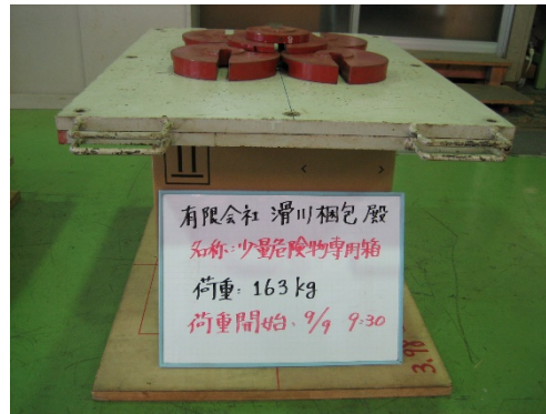
〔積み重ね試験(実荷重 163 kg)〕
